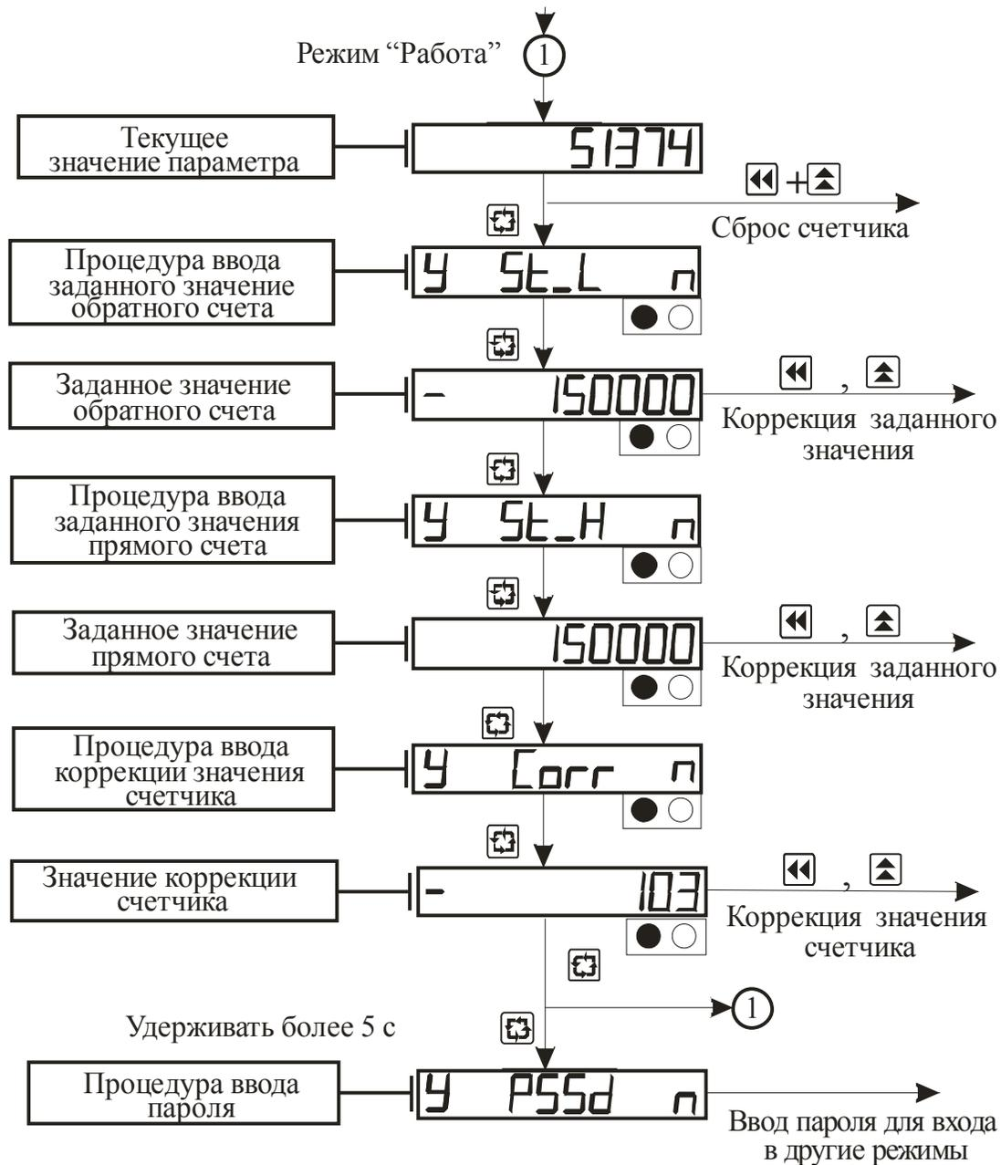
Рисунок 3.3 – Схема алгоритма работы прибора в режиме "Работа"
