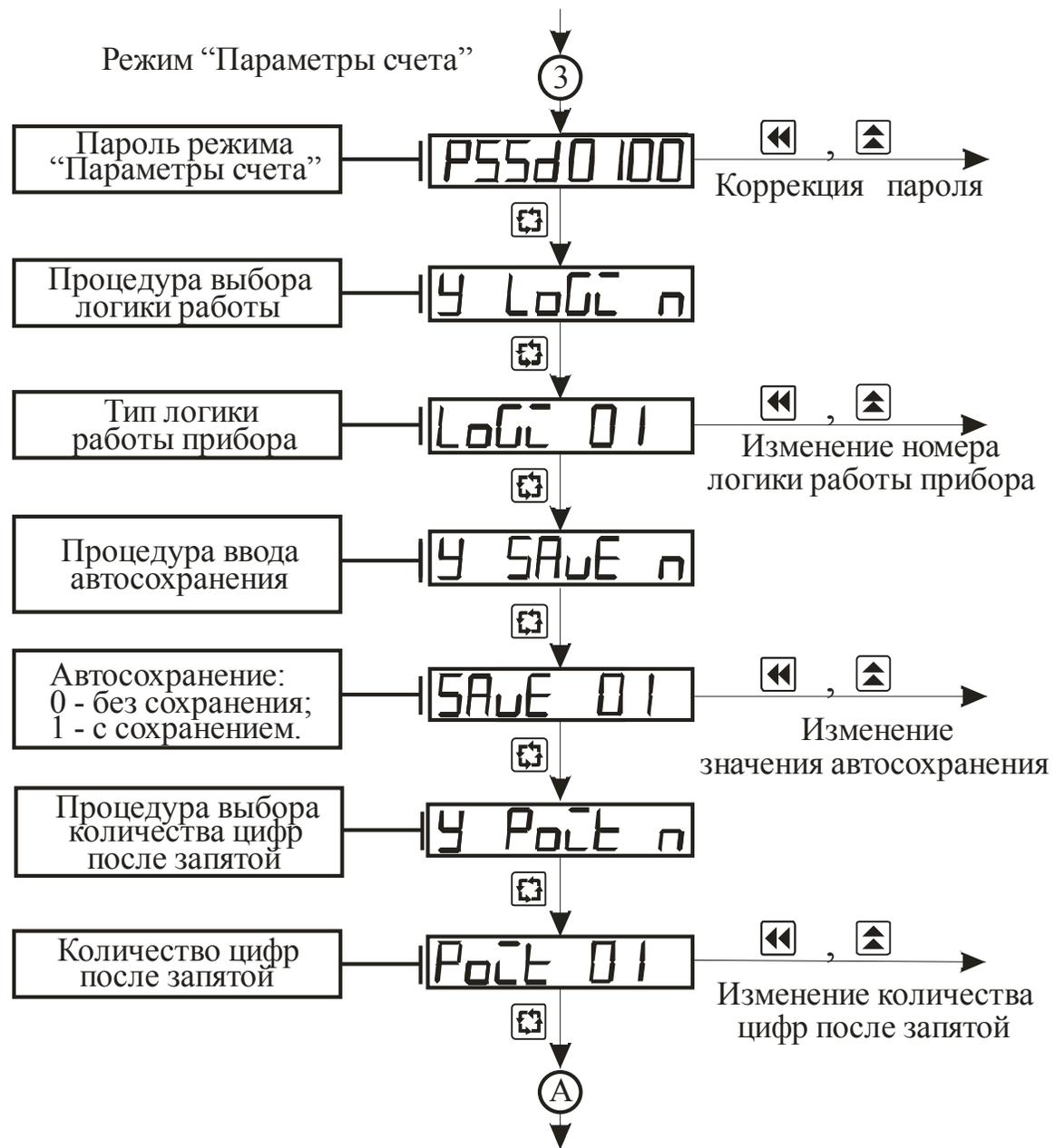
Рисунок 3.6 – Схема алгоритма работы в режиме “ Параметры счета ”
