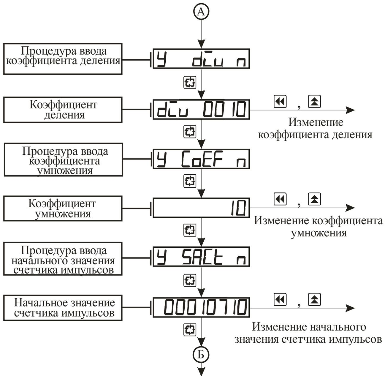
Рисунок 3.7 – Схема алгоритма работы в режиме “ Параметры счета ” (продолжение)
