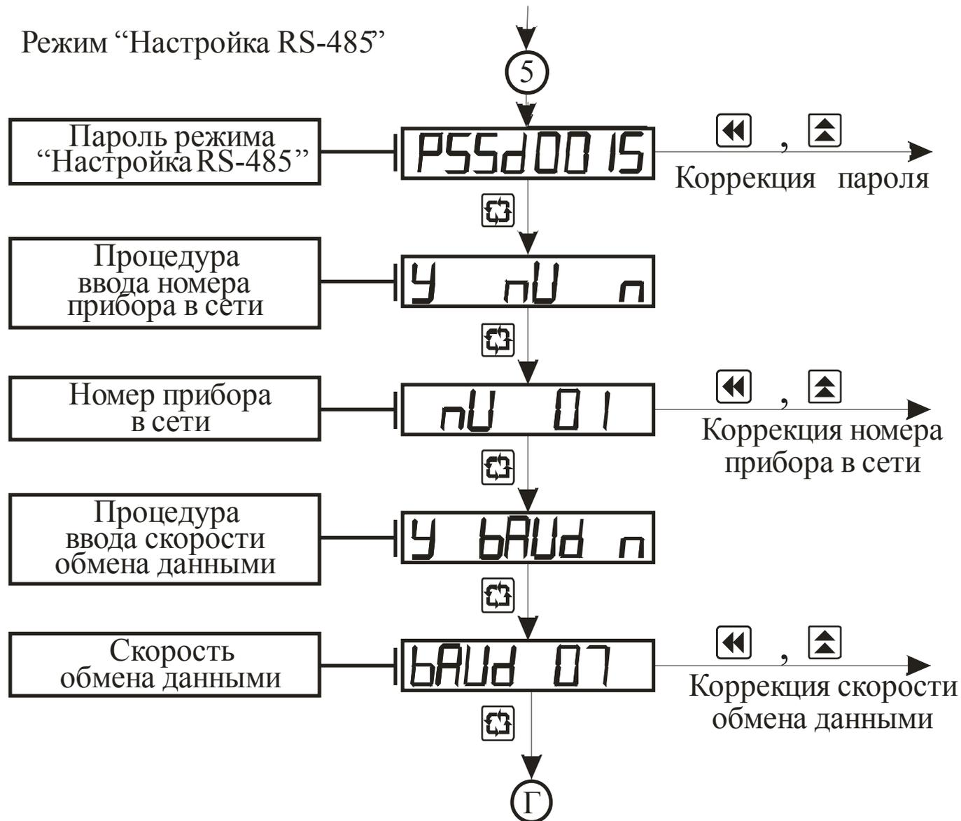
Рисунок 3.12 – Схема алгоритма работы в режиме “Настройка RS-485”
